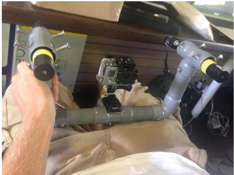
Figure 11: Structure conçue pour l'étude afin d'utiliser la photogrammetrie laser. Crédit photo: Nicolas Boudin.
