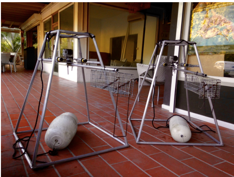
Figure 12: Deux BRUVS conçus pour l'étude, avec deux lasers par structure. Crédit photo: Nicolas Boudin.
